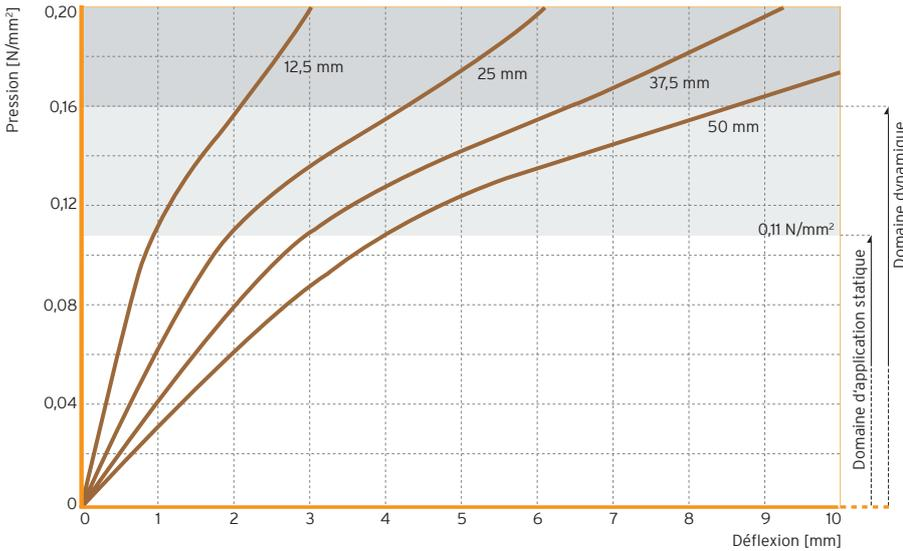
Figure 1 : Courbe de déflexion quasi-statique avec une vitesse de charge de 0,011 N/mm<sup>2</sup>/s
