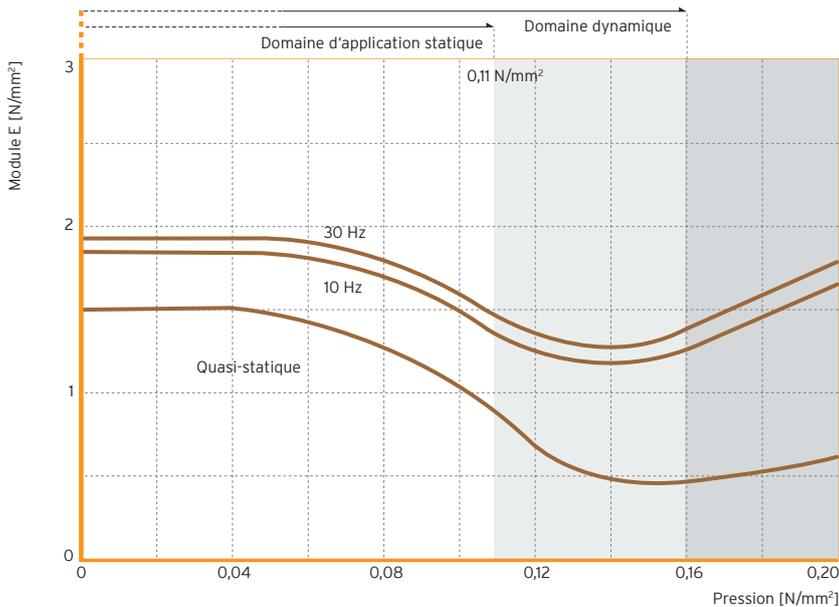
Figure 2 : Valeur de Module E stat. et dyn. en fonction de la pression appliquée.
