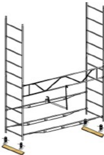
Рисунок 4 – Установить следующие две стойки-лестницы.
