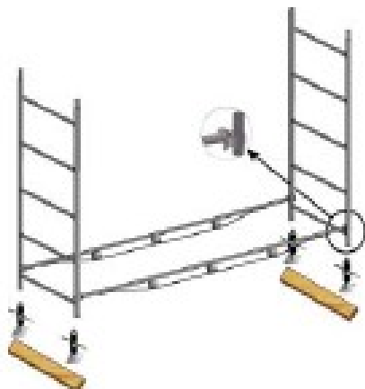
Рисунок 2 - Установить две первые стойки-лестницы и соединить их фермами соединительными. Замки развернуты внутрь лесов как показано на рис.2.
