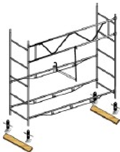
Рисунок 3 - Установить соединительную ферму для держателя настила на высоту около 1500 мм. Установить страховую ферму. На этих двух
