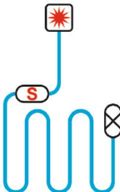
Схема укладки двожильного кабелю
