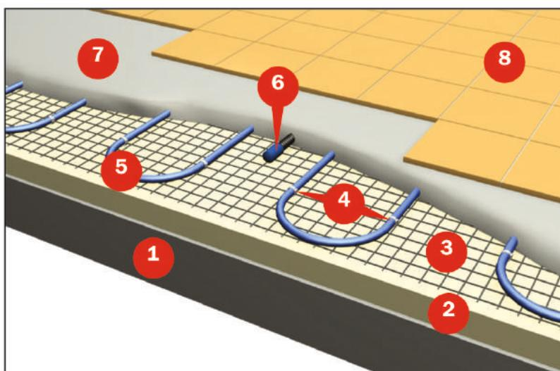
Нагрівальний кабель можна монтувати безпосередньо на тверду теплоізоляцію товщиною від 20 мм використовуючи металеву сітку діаметром дроту від 1 мм. Фіксується кабель до сітки при допомозі пластикових хомутів.
