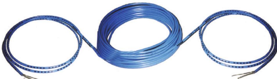
**Одноожильний нагрівальний кабель TXLP/1** складається з двох під'єднувальних проводів живлення, з обох сторін, довжиною 2,25 м та нагрівального кабелю. З'єднані ці частини між собою з використанням унікальних безмуфтових з'єднань. Місця безмуфтових з'єднань позначені на кабелі маркуванням «→ SPLICE ←», під'єднувальні проводи мають маркування «\*\*\*\*\*». По всій довжині кожен кабель має захисний екран у вигляді суцільної алюмінієвої трубки.
