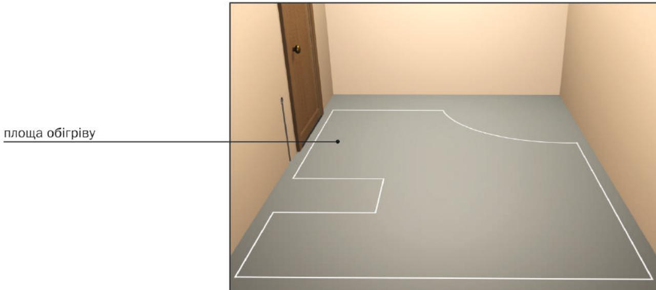
4. На виділеній площи обігріву закріпіть відрізки монтажної стрічки з кроком 0,5–0,75 м так, щоб кріпильні скоби були в одному напрямку.
