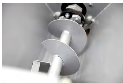
Две дисковые муфты обеспечивают плавное вращение
