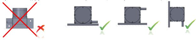
3. Если на энкодер попадает вода, то она не должна стекать вдоль провода. При необходимости, использовать направляющие ролики.
