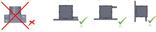
3. Если на энкодер попадает вода, то она не должна стекать вдоль провода. При необходимости, использовать направляющие ролики.
