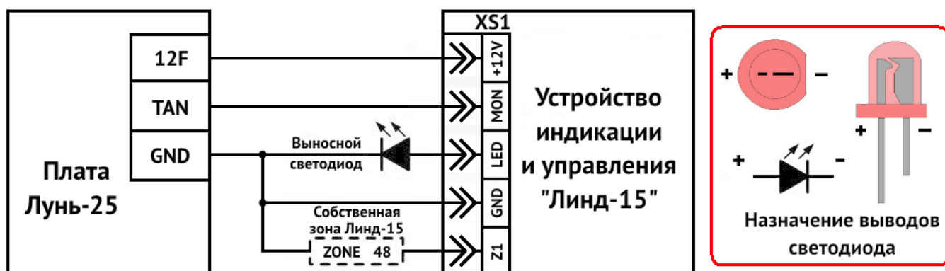
Рисунок 23. Схема подключения УИУ к ППКОП «Лунь-25»
