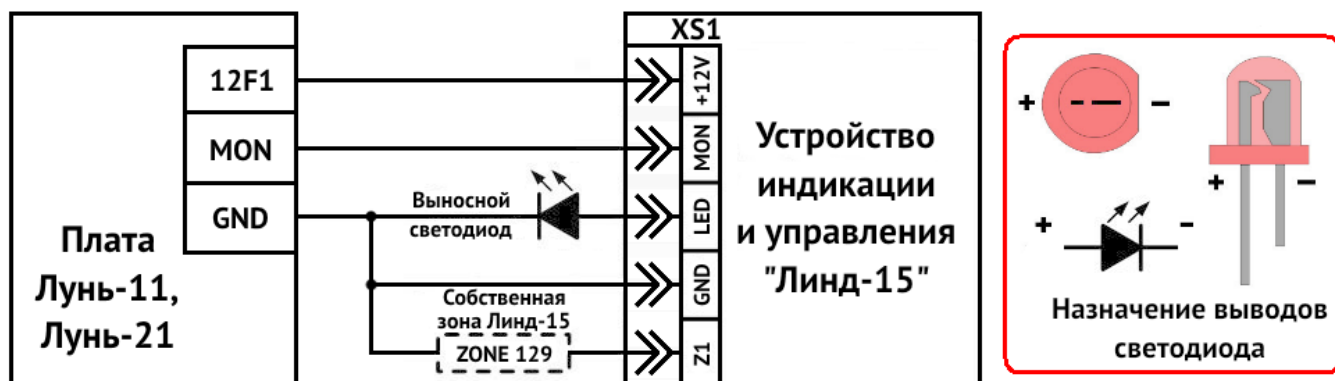
Рисунок 22. Схема подключения УИУ к ППКОП «Лунь-11», «Лунь-21»
