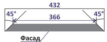
Фасадна кутова планка- деталь з двома зрізами по довжині та кутам у двох площинах під кутом 45°
