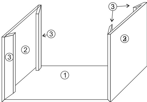
Деталі № 1, 2 та 3 кріпляться між собою на клей та мікро цвяхи. Збірку деталей обов'язково потрібно проводити на рівній поверхні та за допомогою
