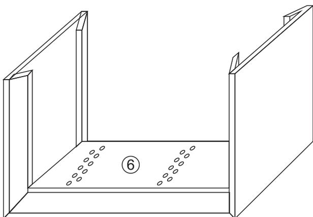
Встановлення на клей та мікро цвяхи низ столу та планки для підсилення жорсткості.
