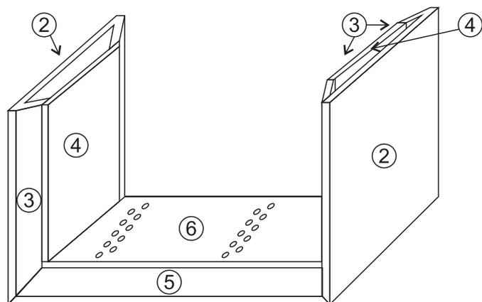
Встановлення та закріплення інших деталей на клей та мікро цвяхи.
