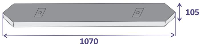
Виготовляється виключно з твердої породи дерева: дуб, акація, ясен. Деталь розмістити, зробити фрезерування-поглиблення під опорні п'яти, розсувної системи, і просвердлити отвори під болт для кріплення. Деталь кріпиться до попередньо склеєних ніжок шурупами L70.
