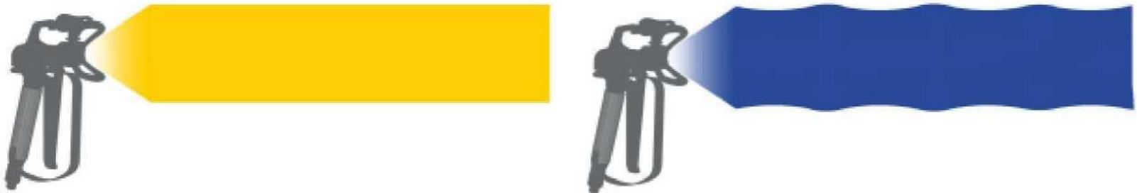
При низком давлении – равномерный факел распыления у мембранного насоса (жёлтым) и несколько более непостоянный факел распыления у поршневого насоса (синим).
