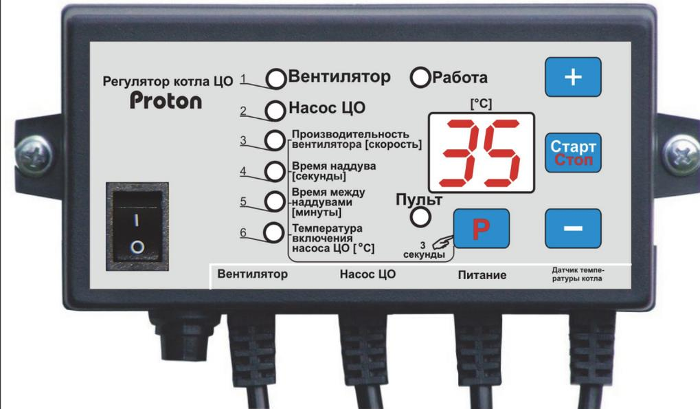
Микропроцессорный регулятор температуры котла центрального отопления (ц.о.) предназначен для управления работой котла ц.о. с вентилятором. Регулятор стабилизирует температуру котла с помощью плавной регулировки оборотов вентилятора, производит наддув в котел (с целью ликвидации накопленных газов, образовавшихся в результате процесса сгорания) и защищает систему центрального отопления от закипания воды. Регулятор управляет работой насоса центрального отопления.
