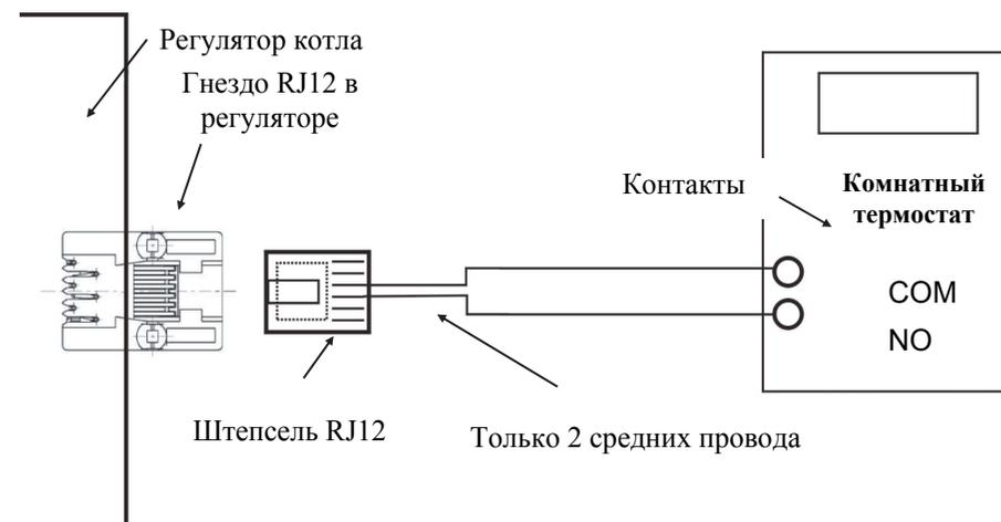
Для подключения следует использовать штепсель RJ12 зажатый на двухжильном телефонном кабеле (круглом или плоском). Кабель, с зажатым на нем штепселе, можно купить в любом магазине электротоваров.
