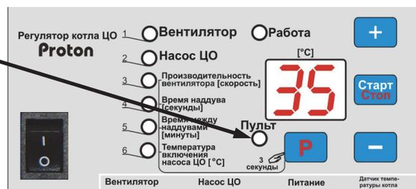
Циркуляционный насос работает еще в течение 30 секунд от момента, когда произошло замыкание контактов термостата, затем циклически включается на 30 секунд через каждые 5 минут. Если температура котла будет выше 80°C, Регулятор включит насос, несмотря на показания комнатного термостата.
