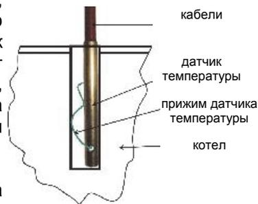
Датчик температуры можно прикрепить на открытой выходной трубе котла ц.о., используя шплинтовое крепление (бандаж). После предварительной затяжки бандажа – как показано на рисунке (бандаж можно обернуть вокруг трубы два раза, или отрезать излишек ножницами для металла), вложить датчик температуры между бандажом и трубой.
