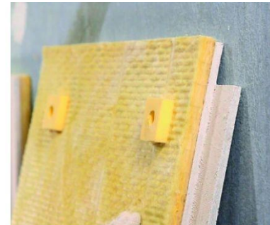
Звукоізоляційні панелі ЗІПС-III-Ультра 1200x600 мм, товщина 43 мм Індекс ізоляції додаткового повітряного шуму \Delta R_w = 11-13 дБ
