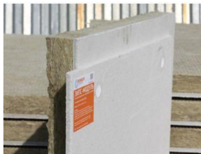
Звукоізоляційні панелі ЗІПС-Модуль 1200x600 мм, товщина 70 мм Індекс ізоляції додаткового повітряного шуму \Delta R_w = 12-14 дБ
