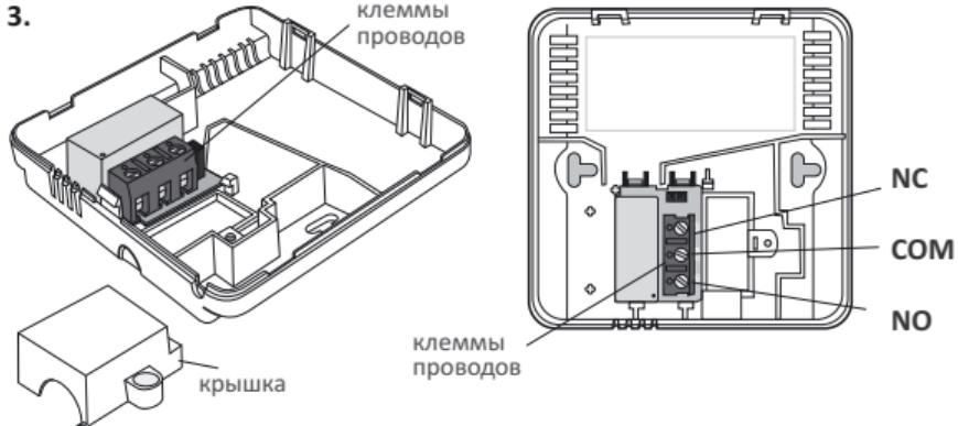
Это типичное однополюсное двухпозиционное реле. В большинстве случаев клемма NC не используется.
