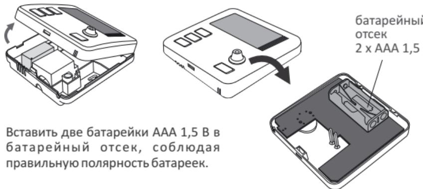
Вставить две батарейки AAA 1,5 В в батарейный отсек, соблюдая правильную полярность батареек.
