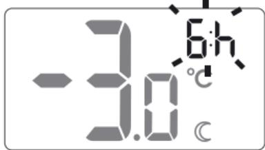
3. Поле часов на дисплее переходит в режим редактирования и мигает. Повторно используя ручку, установить количество часов, на протяжении которых должна быть понижена температура. Это значение можно выбрать из диапазона от 1 до 12 часов. Выбор необходимо подтвердить кнопкой
