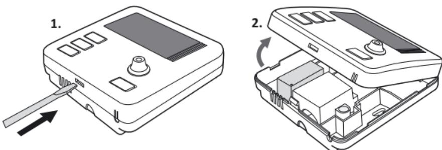
Клеммы проводов расположены на задней стенке регулятора, под пластмассовой крышкой.
