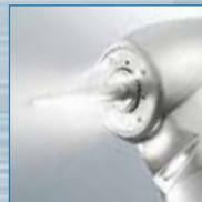
Четырехточечный спрей от NSK эффективно охлаждает всю область обработки, в то время как световод из сотообразного стекла точно освещает необходимый участок.
