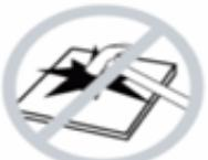
При возникновении трещин на варочной поверхности, необходимо обесточить прибор во избежание удара электрическим током.
