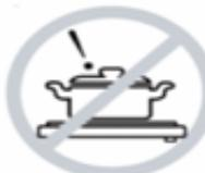
Не используйте варочную поверхность для разогрева кастрюли и сковороды без продуктов питания внутри. В противном случае, ее эксплуатационные свойства могут быть нарушены и это приведет к возникновению опасности.
