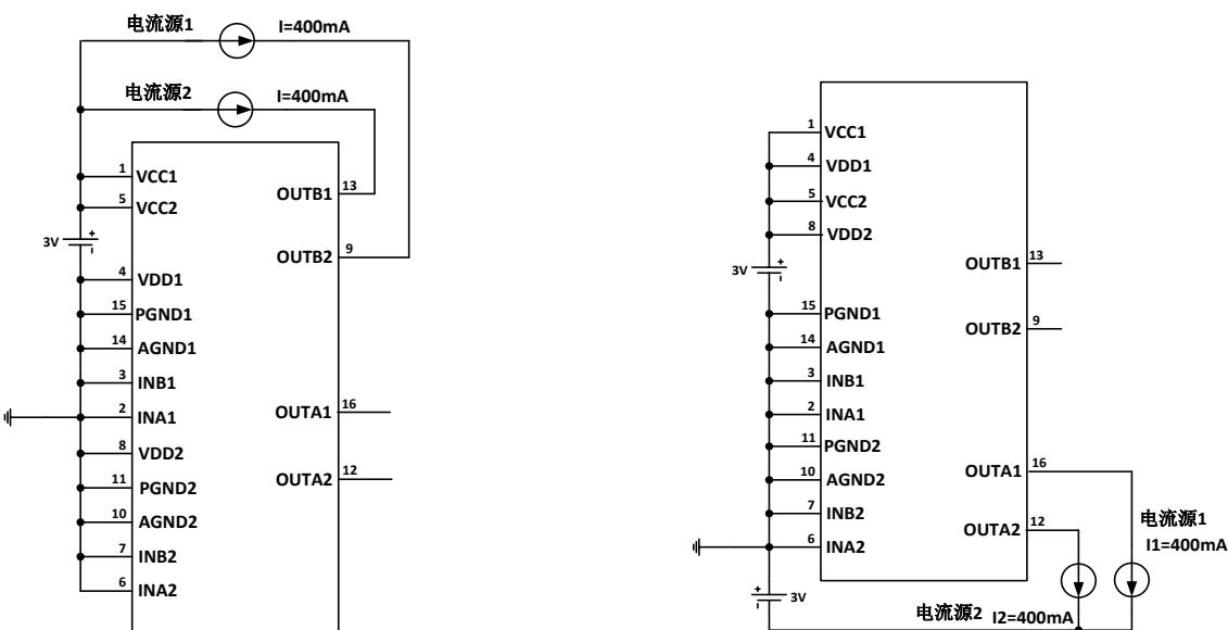
PMOS 体二极管导通电压测试原理图
