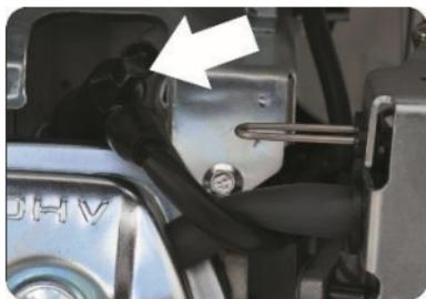
Свеча зажигания: эквивалент TORCH F6TC.
