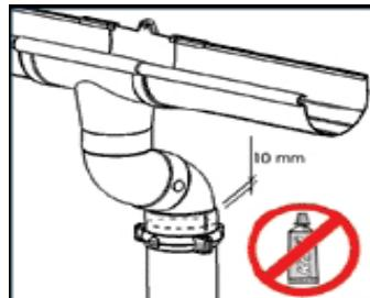
**12.** Непосредственно под отводом устанавливается кронштейн трубы. При вводе труб оставлять зазор примерно 10 мм для компенсации теплового линейного расширения. Клей не используется.
