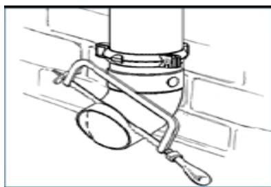
**18.** Нижний отвод можно обрезать параллельно стене для улучшения внешнего вида системы.
