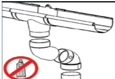
**10.** Монтаж труб начинают от воронки. При небольшом выносе крыши относительно фасадной стены используют муфту трубы или комбинацию одномуфтового и двухмуфтового отводов. Стрелка на муфтах и отводах указывает направление потока воды и всегда направлена вниз.
