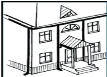
**1.** Перед монтажом системы необходимо определить расположение на фасадах здания водосточных труб, с учетом направления отвода воды, размещения точек наземного водосбора и облика фасада.
