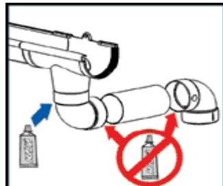
**11.** При значительном выносе крыши между двухмуфтовыми отводами применяется отрезок трубы. При этом обязательно прикрепить верхний отвод к воронке. Возможно применение отводов с углом 87°.
