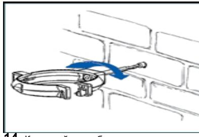
**14.** Кронштейны трубы монтируются на стене посредством универсальных дюбелей и специальных винтов.
