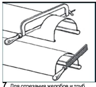
**7.** Для отрезания желобов и труб используется ножовка по металлу. Заусенцы очищаются напильником.
