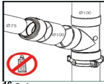
**16.** Тройники устанавливаются аналогично муфтам. В случае соединения трубы 75мм с трубой 100 мм используется адаптер.
