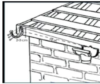
**3.** С помощью шнура определить уровень монтажа желобов (уклон в сторону слива) и установить в высших точках крайние кронштейны желоба.
