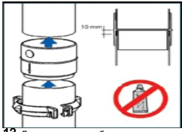
**13.** Для соединения труб применяются муфты. Под муфтой устанавливается кронштейн. Нижняя труба вводится не до конца. Зазор примерно 10мм. Клей не используется.
