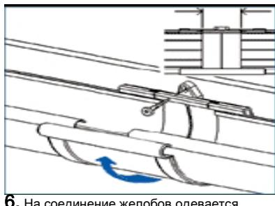
**6.** На соединение желобов одевается муфта. Края желобов должны быть на уровне отметки на муфте.
