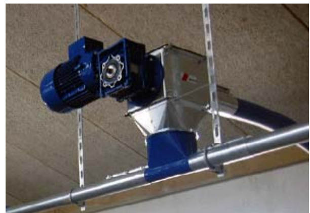
Узел подачи корма в основную линию при помощи гибкого шнека Skiold
