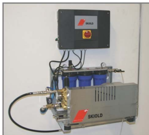
Насос высокого давления и блок управления Skiold
