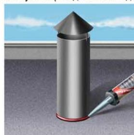
Герметизация кровельных выходов таких как: трубы, окна, фонари и др.
