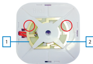
Замыкание контактов 1 и 2 для прописки датчика
