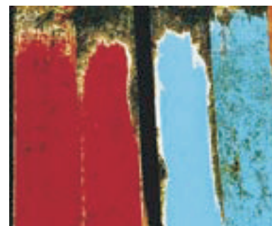
T-ocean тестирует все противообрастающие покрытия на своих плотах. Выше приведён пример из 2 панелей.
