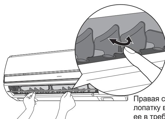
Левая сторона: Возьмитесь за третью слева лопатку вертикальной заслонки и установите ее в требуемое положение. На участок лопатки, за который следует браться, нанесена маркировка.
