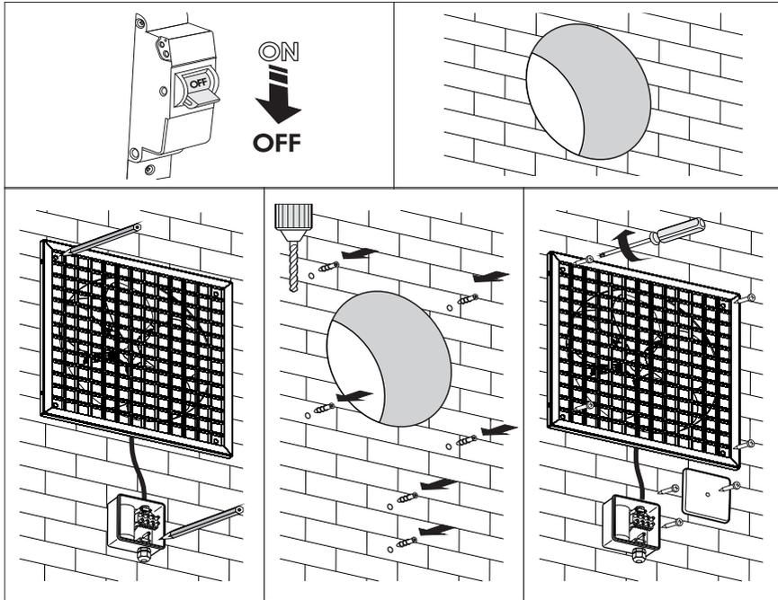
Вентилятор серии ВКФ устанавливается в канал при помощи соединительных фланцев. Вентиляторы должны быть смонтированы так, чтобы направление стрелки потока на корпусе совпадало с направлением движения воздуха в системе. Подача питания на вентилятор осуществляется через выносную клеммную коробку. Монтаж ВКФ:
