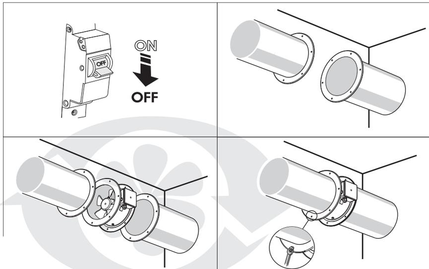
Вентиляторы серии ОВП устанавливаются в канал при помощи хомутов. В комплект поставки ОВП входят монтажные кронштейны для крепления изделия к потолку или стене. Поддача питания осуществляется через клеммную коробку на корпусе вентилятора. Монтаж ОВП:
