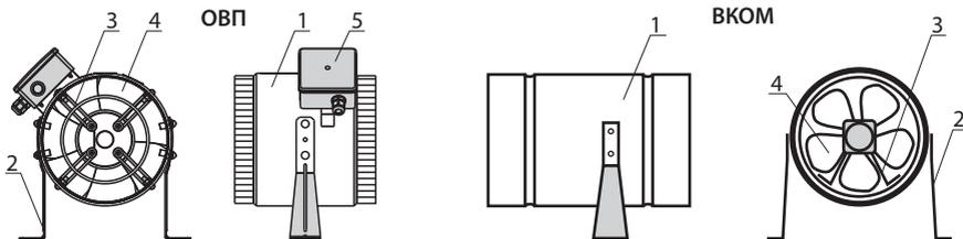
**Вентилятор ОВ1 Р** состоит из стального корпуса 1 с квадратным фланцем. Корпус имеет полимерное покрытие. Двигатель и крыльчатка 5 установлены внутри корпуса на кронштейне. Пластмассовая решетка 2 установлена в корпусе 1 и зафиксирована рамкой 3. Вентилятор ОВ1Р имеет клеммную коробку 4 на шнуре для электрического подключения.
