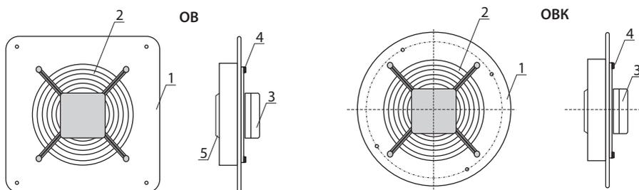
**Вентиляторы ОВ1 и ОВК1** состоят из стального корпуса 1 с полимерным покрытием, с квадратным для ОВ1 и круглым для ОВК1 фланцем, к которому болтами 4 крепится решетка 2. Двигатель и крыльчатка 5 закреплены внутри корпуса на кронштейне. Вентиляторы ОВ1, ОВК1 имеют клеммную коробку со шнуром для выносного подключения.
