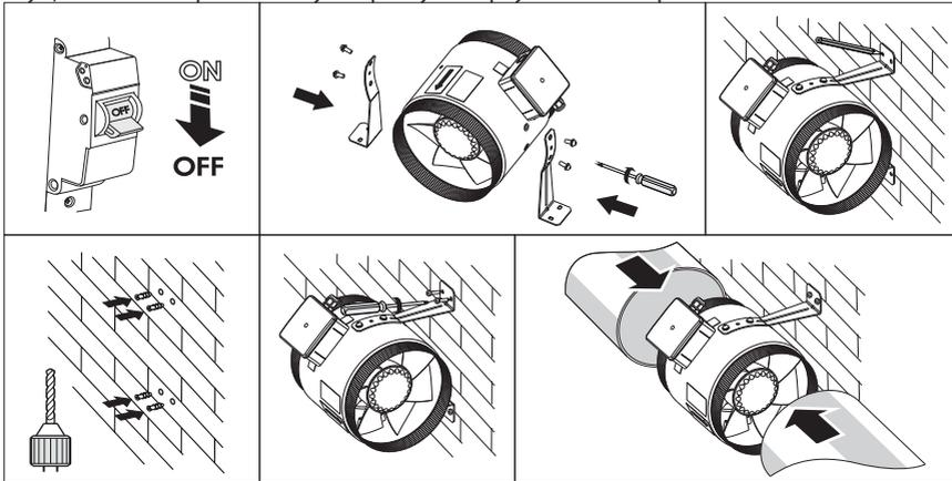
Вентиляторы серии ВКОМ устанавливаются в канал при помощи переходника РМ, который соединяет воздуховоды разного диаметра, конструкция фиксируется хомутами. В комплект поставки ВКОМ входят монтажные кронштейны для крепления изделия к стене. Поддача питания осуществляется через выносную клеммную коробку. Монтаж ВКОМ:
