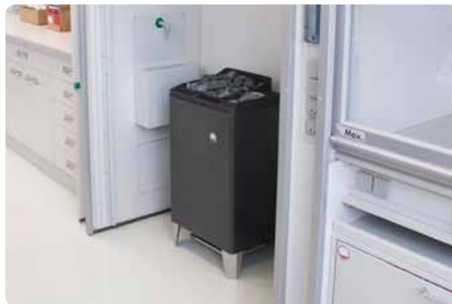
Вытяжной шкаф с настоящей печью для сауны для тестирования ароматов для сауны
