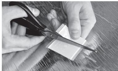
Рис. 7. Разрезание битумной изоляции на 2 части
