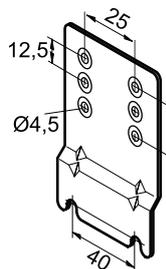
**Монтажная пластина с крышкой для установки отдельных устройств**
