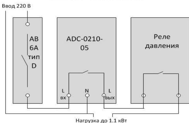
Подключение устройства должно производиться квалифицированным электриком. Устройство предназначено для установки внутри помещений. Необходимо исключить возможность попадания влаги или жидкости при эксплуатации. Конструктив устройства требует для крепления наличия DIN-рейки. Занимаемая ширина - 54 мм (три стандартных модуля).
