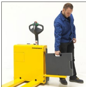
Боковая замена аккумуляторной батареи
