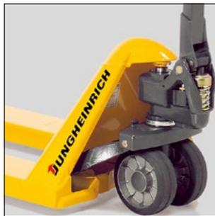
Прочные соединения со специальной смазкой не требуют технического обслуживания
