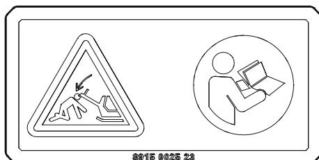
В поднятом состоянии рукоятка должна быть заблокирована. См. инструкцию по эксплуатации.
