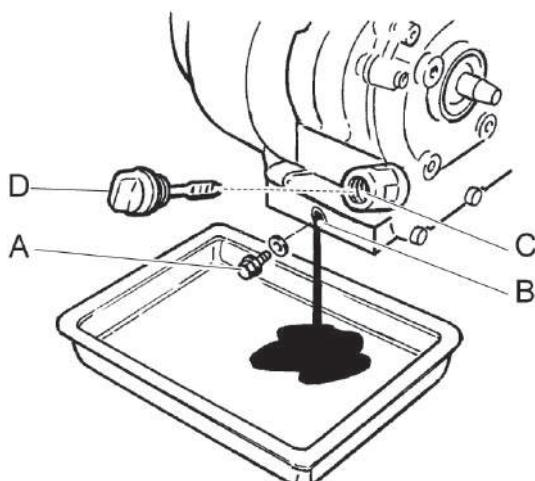
2. Наклоните устройство назад и дайте маслу стечь в сливной шланг.
