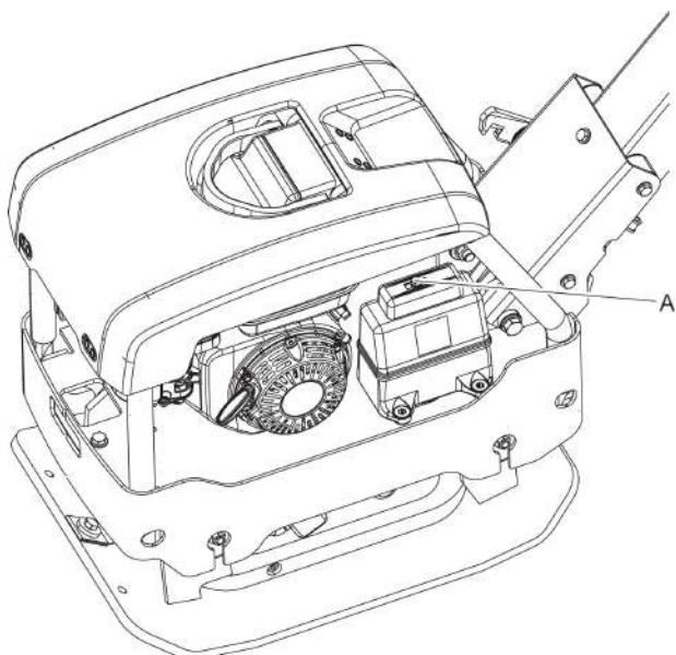
2. С помощью маслозаборного патрубка слить гидравлическое масло из бака.
