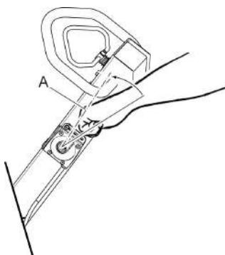
2. Если двигатель холодный, закрыть дроссельный клапан. В случае прогретого двигателя или высокой температуры
