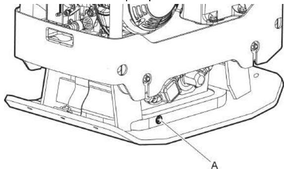
2. Наклонить машину.
