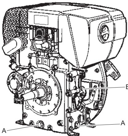
2. Наклоните устройство назад и дайте маслу стечь в сливной шланг.
