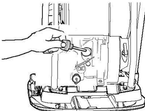
2. Залить топливо в топливный бак.
