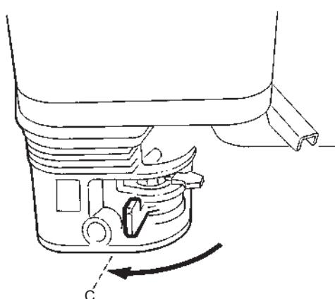
**Остановка двигателя, Hatz с электрическим запуском**
