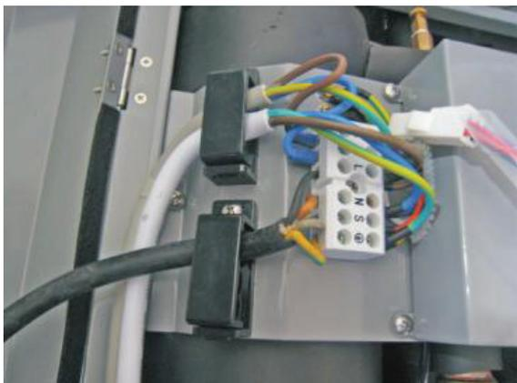
5. С помощью кабельного ввода закрепите кабель, чтобы он не ослаб.
