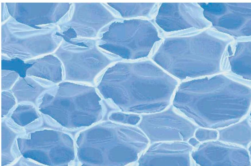
Структура пенополиуретана имеет небольшое количество твердого вещества. Масса материала, около 30 кг/м<sup>3</sup>, содержит твердого полимера всего лишь 3% от общего объема, который создает достаточный сеточный каркас из клеточных оболочек и перегородок, что позволяет выдерживать механические нагрузки.
