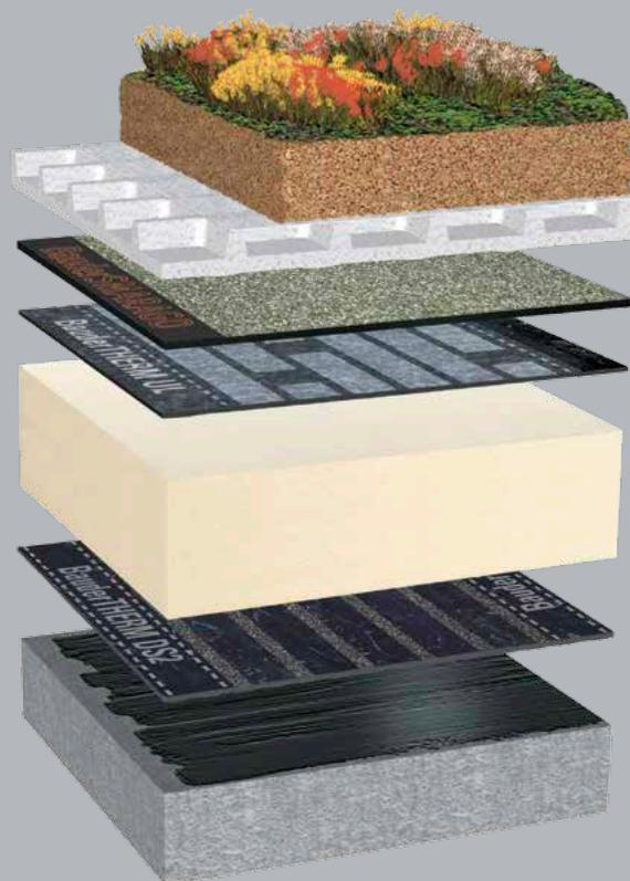
Пример кровельного пирога: BauderPIR M с последующей двухслойной полимербитумной гидроизоляцией и системой кровельного озеленения
