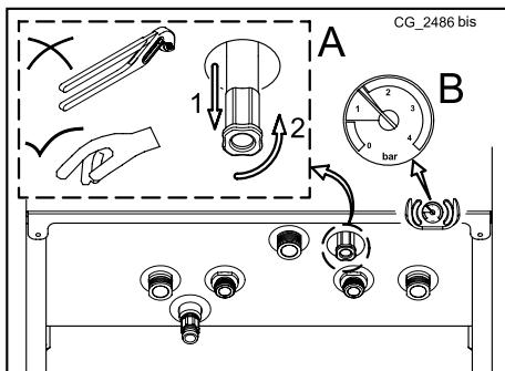
**!** Котел оборудован гидравлическим реле давления, которое отключает котел в случае недостаточного давления в контуре отопления.
