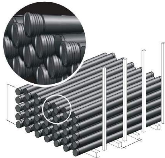
Рис.15. Максимальная высота складирования труб навалом (без оригинальной упаковки).
