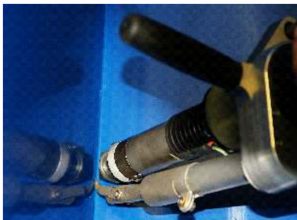
Micro – приваривание ПВХ-плит к контейнеру.
