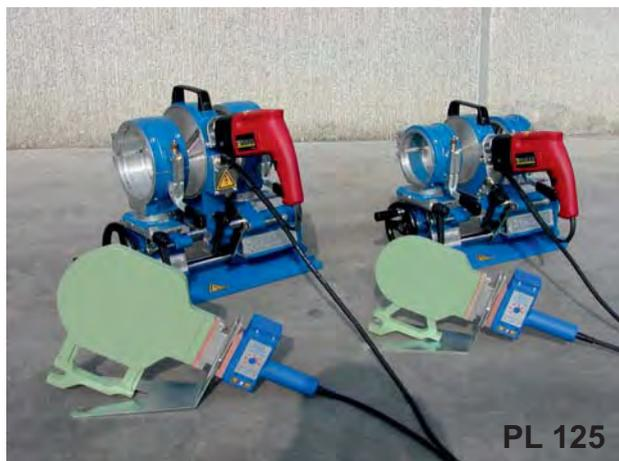
Машины для сварки труб типа PL являются стабильными и надёжными сварными машинами. Благодаря прецизионным линейным направляющим в крутильно-жесткой основной станине, она даёт пользователю высокую степень точности и допустимой нагрузки.
