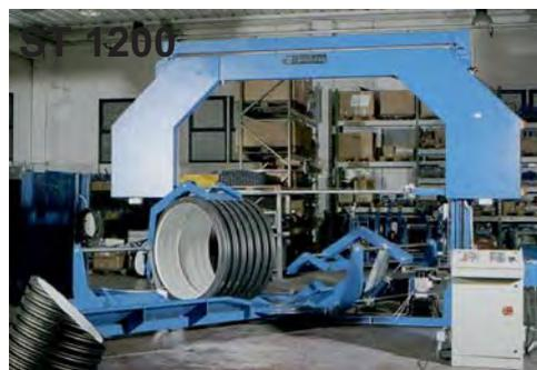
Ленточные пилы типового ряда (серии) ST оснащены гидравлическим приводом, а также CNC (ЧПУ). Они сконструированы для прецизионного распиливания профилей и фасонных деталей из PE, PP, а также из других термопластических материалов. Благодаря поворотной стойке пилы, могут быть распилены трубы различного диаметра, а также сделаны косые срезы (под углом до 67,5°). Опускание стойки пилы, а также закрепление труб осуществляется с помощью прецизионного гидравлического привода.
