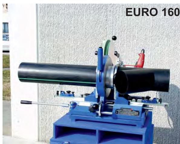
Машины для сварки труб ряда WORLD и EURO являются лёгкими и подходят для различных применений в цехах. Они позволяют пользователю обработку труб из PE и PP, а также фитингов в области до SDR 11.
