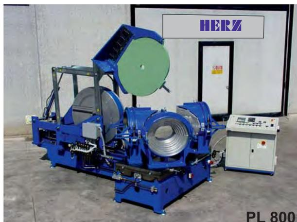
Нагревательный элемент с покрытием, а также электродторцеватель соединены с основной станиной машины. Для закрепления отдельных трубных сегментов имеются инструменты в различном исполнении. Для изготовления Т-образных (45°, 60° и 90°), Y-образных, а также X-образных сварочных швов для отдельных типов машин были разработаны специальные зажимные инструменты.
