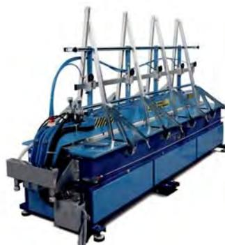
Рычаги для бокового размещения деталей также убираются вверх, и таким образом можно избежать ненужного использования пространства при неиспользовании машины.
