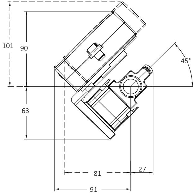
MULTICAL® 602 установленный на стене, вид сбоку
