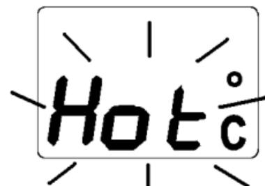
Защита от перегрева отключает силовое реле в случае превышения допустимой максимальной нагрузки или перегреве контактов клемного зажима, тем самым повышая пожарную безопасность устройства и продлевая его ресурс.
