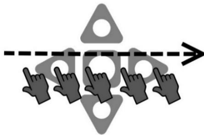
Рисунок 2.1 – Принцип спрацювання оптичних кнопок (приклад переміщення «вправо»)
