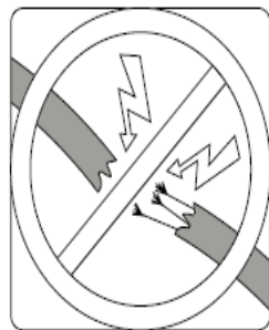
Перевірити цілісність кабелів
