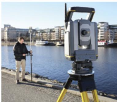
Отражатели Trimble специально разработаны для геодезистов и инженеров-строителей, как надежное, прочное и простое в работе решение для роботизированной съемки. Новый ActiveTrack 360 представляет собой легкий и компактный отражатель для оптических измерений с использованием передовых технологий активного слежения Trimble.
