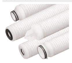
Membranfilterkerzen werden aus hochwertigem asymmetrischen Polyethersulfon hergestellt. Die Membrane werden durch Stützvliese aus Polypropylen geschützt. Ein innerer Stützkern, ein äußerer Stützkäfig und Endkappen aus Polypropylen garantieren mechanische Stabilität.
