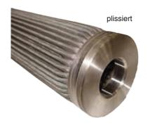
SSMA Edelstahlfilterkerzen sind robuste und vielseitig einsetzbare Siebelemente. Die Edelstahlgewebe werden bei der Herstellung über einem stabilen Stützkern aus Edelstahllochblech aufgezogen und an den Endkappen ohne Kleber oder Bindemittel fixiert.
