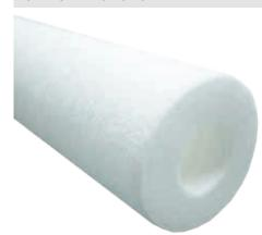
PPBB Filterkerzen werden im Melt-Blow-Verfahren hergestellt, wobei mit drei verschiedenen Sprühdüsen feinere und gröbere Endlosfäden zu einer Multi-Layer-Struktur verarbeitet werden.
