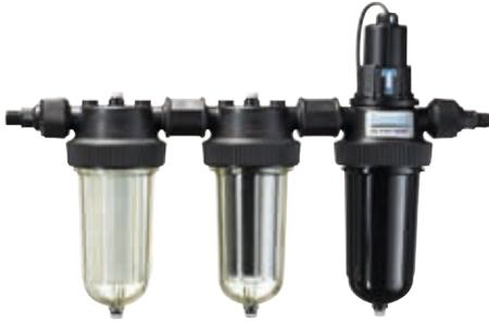
Das einfache und effiziente System zur Wasserentkeimung. UV-Bestrahlung mit 253,7 Nanometer simuliert einen Teil der Sonnenstrahlen, welche bei diesem System künstlich erzeugt werden. Die entstehenden UVC Strahlen sind erheblich intensiver als Sonnenlicht. Schwebepartikel beeinträchtigen das Ergebnis, deshalb empfehlen wir eine Vorfiltration, z.B. mit der 3-stufigen Filtration des TRIO-UV.
