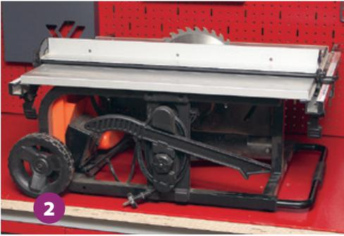
с помощью четырёх рычажков, находящихся по углам рабочего стола. При установке упора на заданное расстояние как минимум два из них будут задействованы. Этого достаточно.
