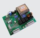
Встроенный двигатель Milord 5 C e Milord 8 C Блок управления для работы с одномоторными приводами до 600 Вт для раздвижных ворот.
