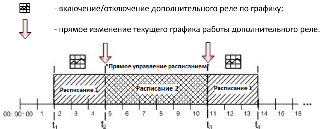
Рисунок 7.5.8 Прямое управление графиком работы дополнительного реле (пример)
