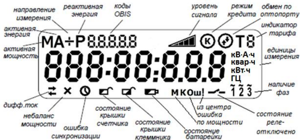
Рис. 4.2. Вид русифицированного дисплея счетчика. В тестовом режиме все сегменты активны.
