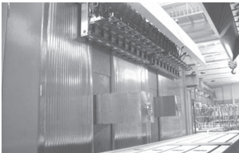
Защитный мех с пластинами в поперечном положении на обрабатывающем станке
