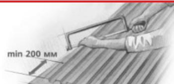
4. При резке листов, которая осуществляется при помощи ручной пилы по металлу или электромеханического резака с карборундовым диском (2500 об/мин), их необходимо придерживать возле места разреза, избегая давления и вибрации.
