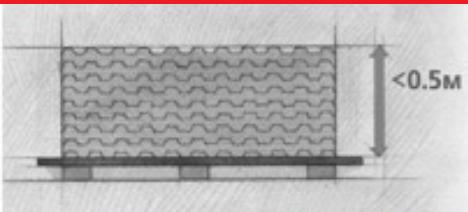
4. Допустимая высота стопки монолитных профилированных поликарбонатных листов при складировании составляет не более 0,5 м
