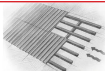
3. Листы укладываются рядами в направлении, обратном направлению преобладающего ветра, снизу вверх. Необходимо обеспечить хорошую вентиляцию и проветривание уложенных листов.
