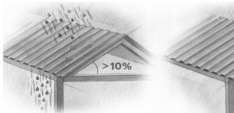
1. Листы монолитного профилированного поликарбоната применяются на крышах с уклоном от 6%. Уклон обеспечивает самомойку крыши дождевой водой.
