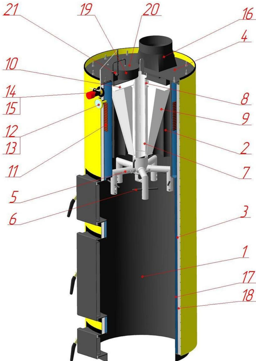
Рис. 1 Устройство котла
