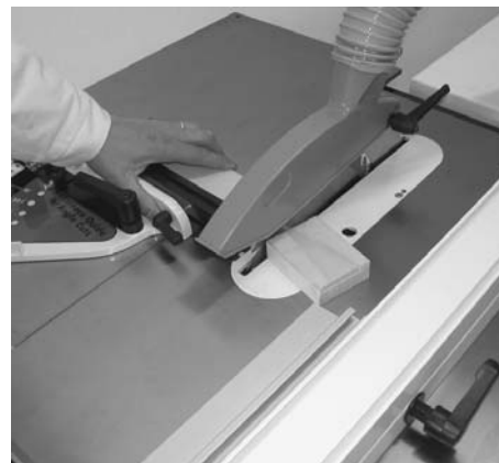
А.3. Поперечный распил при помощи упора
